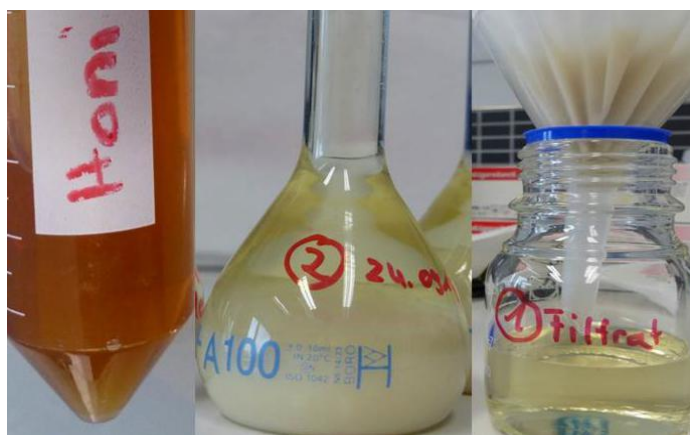
Рис. 2 Підготовка вимірювання питомого оберտання меду: Після осадження білків та інших частинок, використовуючи розчин Карреса I та розчин Карреса II (середня колба на рисунку), а також після фільтрації (колба, що розташована справа на рисунку), чистий фільтрат створено. Для даного фільтрату можна легко проводити вимірювання за допомогою поляриметрії.
